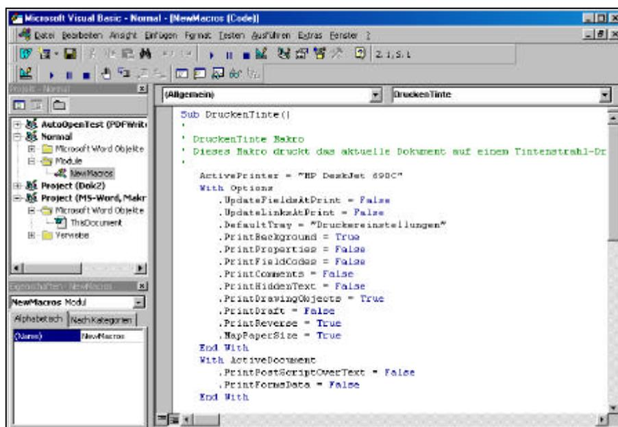
Im rechten Teil des Fensters werden die aufgezeichneten Makros angezeigt. Im linken Teil des Fensters sehen Sie den sogenannten Projekt-Explorer. Im Projekt-Explorer werden die verschiedenen geöffneten Dokumente (Visual-Basic-Projekte) und die darin enthaltenen Objekte angezeigt. Ähnlich wie beim Explorer können Sie durch Klicken auf die Plus und Minuszeichen untergeordnete Strukturen sichtbar machen oder ausblenden.
