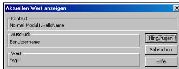
In diesem Fenster werden Name, Wert und Kontext der ausgewählten Variable angezeigt. Klicken Sie auf den Aktionsschalter Hinzufügen und die Anzeige erfolgt dauerhaft im Überwachungsfenster.
