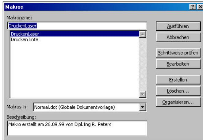
In der Auswahlliste werden die Namen der verfügbaren Makros in dem ausgewählten Dokument bzw. der ausgewählten Vorlage angezeigt. Wenn Sie ein Makro auswählen, wird unterhalb der Auswahlliste zusätzlich angezeigt, wer das Makro wann erstellt hat. Klicken Sie den Aktionsschalter ausführen, um das ausgewählte Makro auszuführen. Alle Aktionen, die Sie zuvor aufgezeichnet haben, werden nun automatisch abgespielt. Das Dokument wird mit den gewählten Einstellungen gedruckt.
